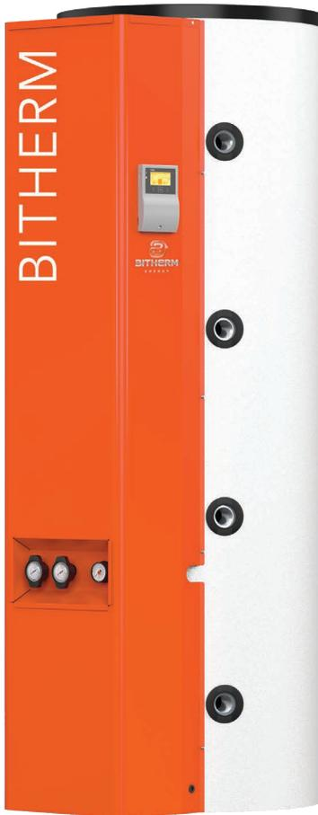
La Centrale BITHERM est un ballon de 401 L \* avec un échangeur relié à des panneaux solaires thermiques où circule un fluide caloporteur (glycol) afin de chauffer l'eau du ballon pour alimenter le chauffage central existant.
